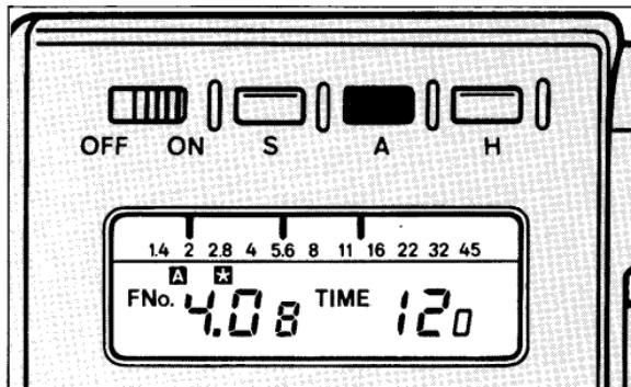
Si une autre mesure est faite quand “**A**” est affichée, le posemètre indique l'écart de luminosité entre la valeur moyenne et la dernière mesure. Pour de plus amples informations, se référer à la page 87.
