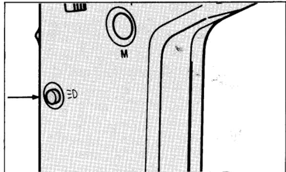
L'affichage dans le viseur peut être éclairé afin de faciliter la lecture de la mesure en faible lumière, il suffit pour cela d'appuyer sur le bouton situé sur la poignée du posemètre.
