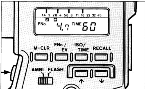
ment, un troisième index apparaîtra sur l'échelle analogue pour indiquer le nombre  $f$ . Une “ $\pm$ ” apparaîtra également à chaque nouvelle mesure afin de témoigner des écarts de luminosité à partir de la valeur calculée. Ces mesures seront indiquées par quatre index sur une échelle analogue à la mesure.
