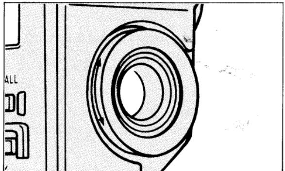
Le Spotmètre F est équipé d'un objectif à mise au point fixe pour une plage comprise entre 1,3 mètre et l'infini. Pour compenser les écarts de vues de chaque personne, l'oculaire du posemètre est ajustable de -2,5 à + 1,2 dioptres. Cet ajustement s'effectue en regardant au travers du viseur et en tournant l'oeilletton de l'oculaire vers la droite ou la gauche jusqu'à ce que le cercle au centre ( $1^\circ$ ) apparaisse net.
