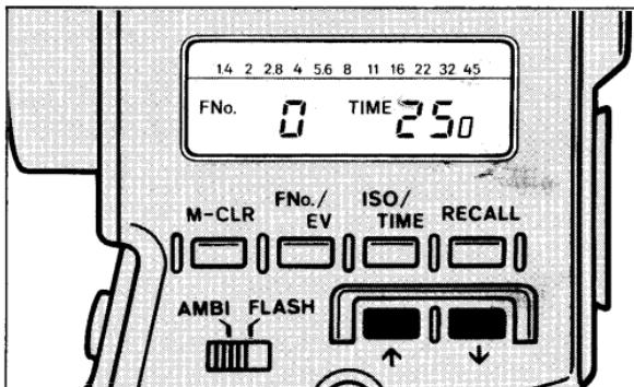
Après avoir sélectionné la sensibilité de film, appuyer sur la touche ISO/TIME pour afficher le mode TIME (vitesse d'obturation). L'affichage indique la plus récente vitesse sélectionnée. Si la pile vient d'être mise en place, le "60" (1/60) apparaît.
