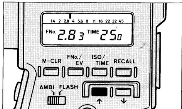
5. Reporter sur l'appareil la vitesse d'obturation et l'ouverture de diaphragme indiquées par l'affichage digital du posemètre. Si désiré, d'autres couples vitesse/diaphragme peuvent être obtenus en appuyant sur les touches d'accroissement ou de diminution.
