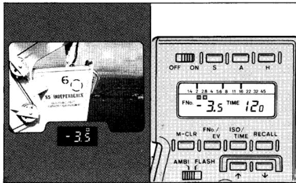
Si une autre mesure est faite, une “★” apparaît, le posemètre indiquera l'écart de luminosité entre la mesure des fortes lumières et la nouvelle mesure.
