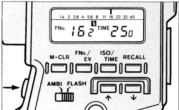
5. Appuyer sur le bouton de mesure pour déclencher le flash et obtenir une mesure.
