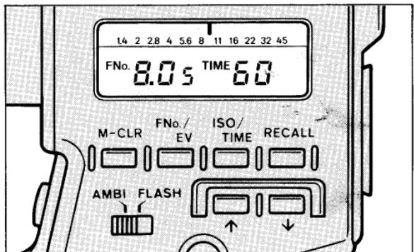
Le Spotmètre F dispose de deux modes de mesure affichée, le nombre f (ouverture de diaphragme) et IL (indice de lamination). Appuyer sur la touche FNo/IL pour obtenir l'affichage souhaité dans l'écran ACL.
