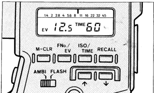
L'indice de lumination (IL) est très utile pour le contrôle du ratio de contraste (p. 87), de la luminance (p. 88) et autres conditions d'éclairement. Sur cette position, l'affichage se fait par palier en IL et ne change que si la valeur ISO est modifiée ce qui affectera la valeur IL affichée.
