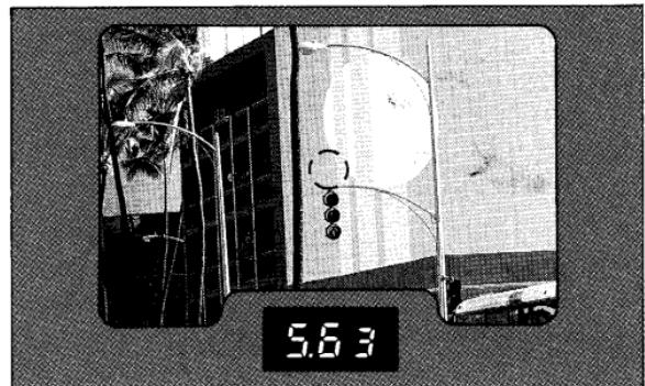
3. Regarder au travers du viseur et positionner le cercle de 1° sur la plage à mesurer.
