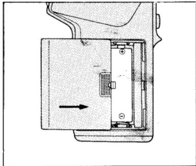
Le Spotmètre F est alimenté par une seule pile de type AA 1,5 Volt alcaline-manganèse, carbone-zinc ou 1,2 Volt nickel-cadmium.
